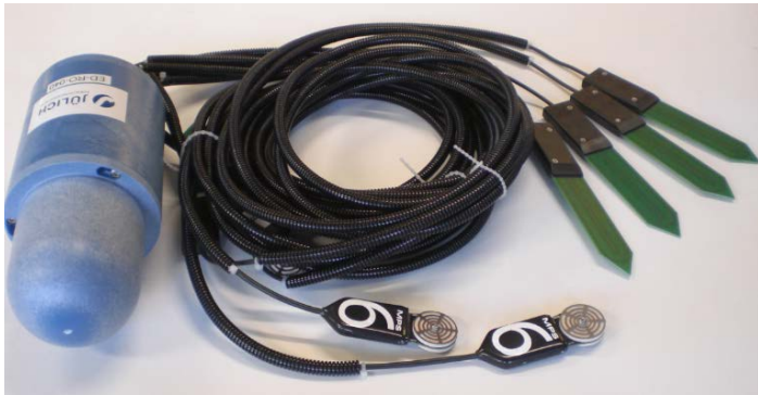
SoilNet-Knoten mit Bodenfeuchte- und Matrixpotential-Sensoren
