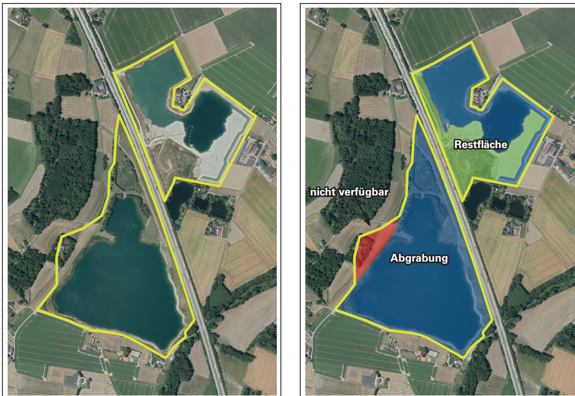
Abb. 8: Links: Verschneiden der Orthophotos mit den Abgrabungsflächen (gelb); Rechts: Identifizieren und Digitalisieren der „aktiven Gewinnungsflächen“ (blau), „Restflächen“ (grün) und „nicht verfügbare Flächen“ (rot)
