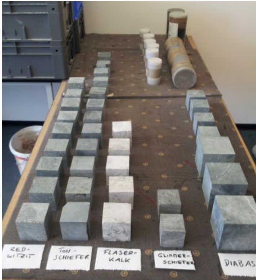
Abbildung 30: Übersicht über einige Proben im Ringversuch "Wärmeleitfähigkeiten" der SGD (Foto: LfU BY)
