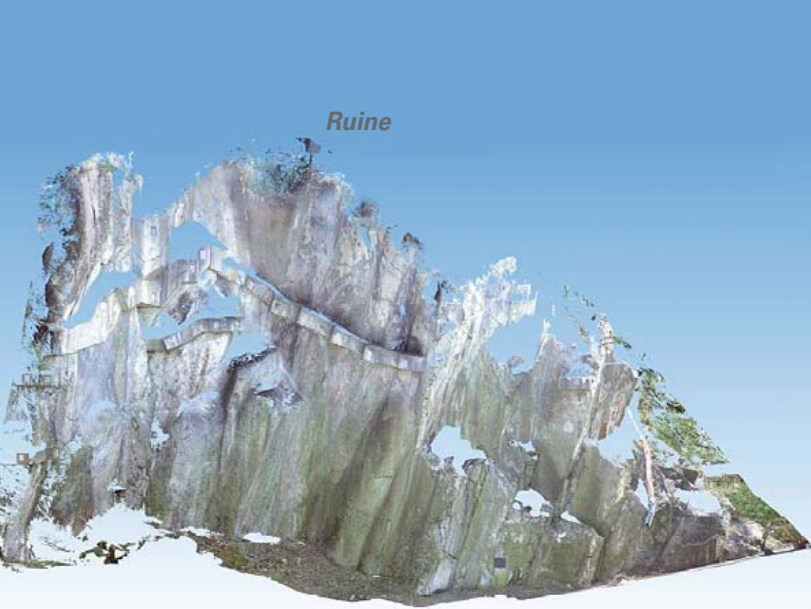
Laserscan der Felswand
